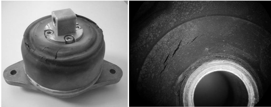
Abbildung 2.1: Thermisch bis zur Zerstörung gealterte Elastomerbauteile [15]
