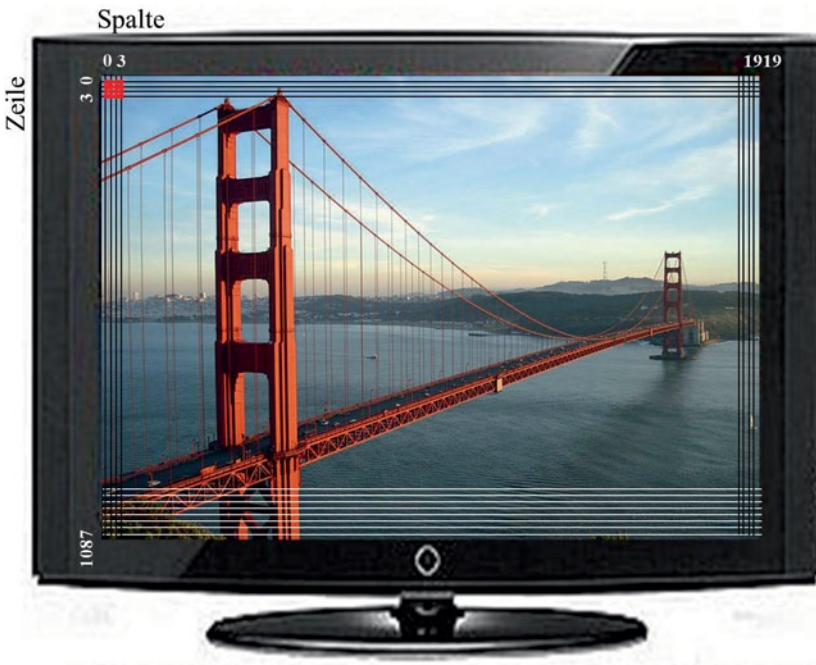
Abb. 2.3 Rasterprinzip beim HD-TV
