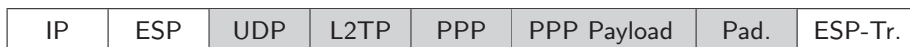
Abb. 2.6 Ein Paket des L2TP-Protokolls. Die grau unterlegten Felder sind mit IPSec ESP verschlüsselt.
