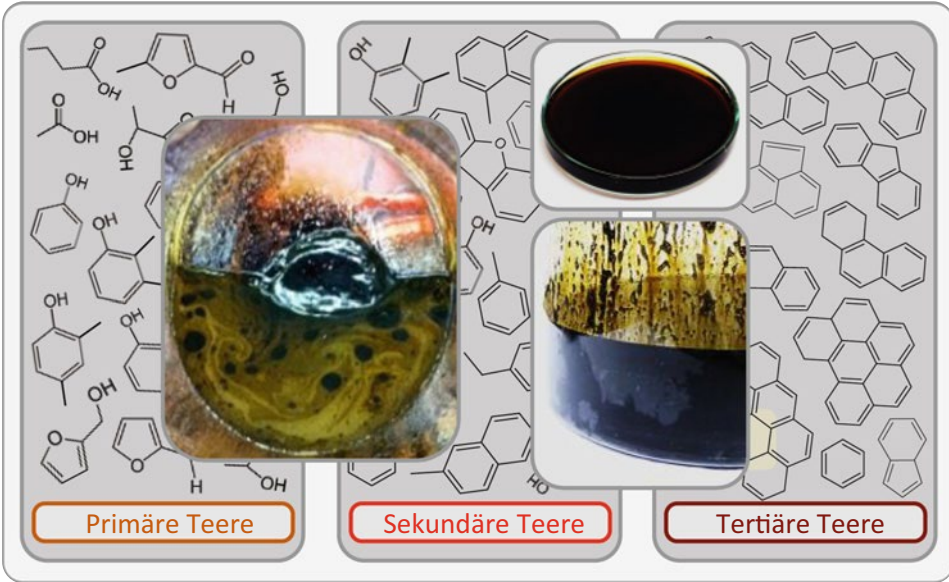
Abb. 2.6 Typische Strukturkomponenten von primären, sekundären und tertiären Teeren, verändert nach [362] sowie Fotos verschiedener Teerproben
