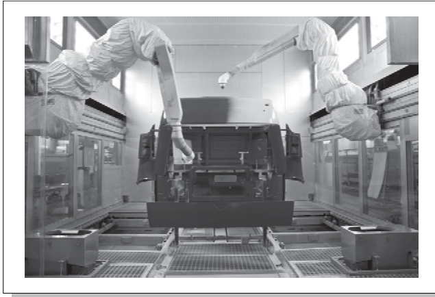
Abbildung 2.7: Lackierung einer LKW Karosserie, Quelle: Daimler AG (2012a)
