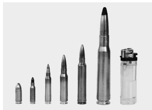
■ Abb. 9.1 Eingeführte Patronen der Bundeswehr. Von links nach rechts: 9 mm × 19, 4,6 mm × 30, 5,56 mm × 45, 7,62 mm × 51, 7,62 mm × 67, 12,7 mm × 99, zum Größenvergleich: Feuerzeug. (Foto: Dr. Christian Neitzel)
