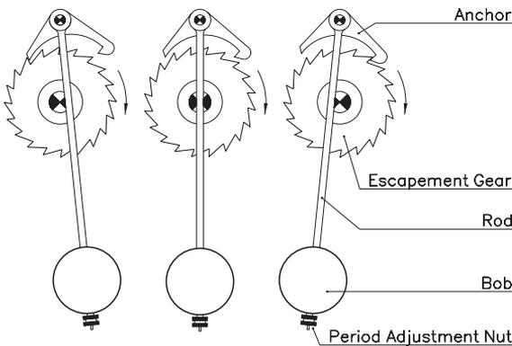
Fig. 3.13. Pendulum escapement
